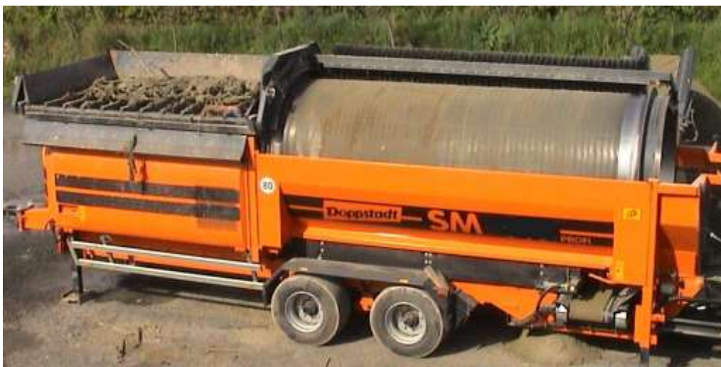
Fig. 1 - Vaglio rotante
